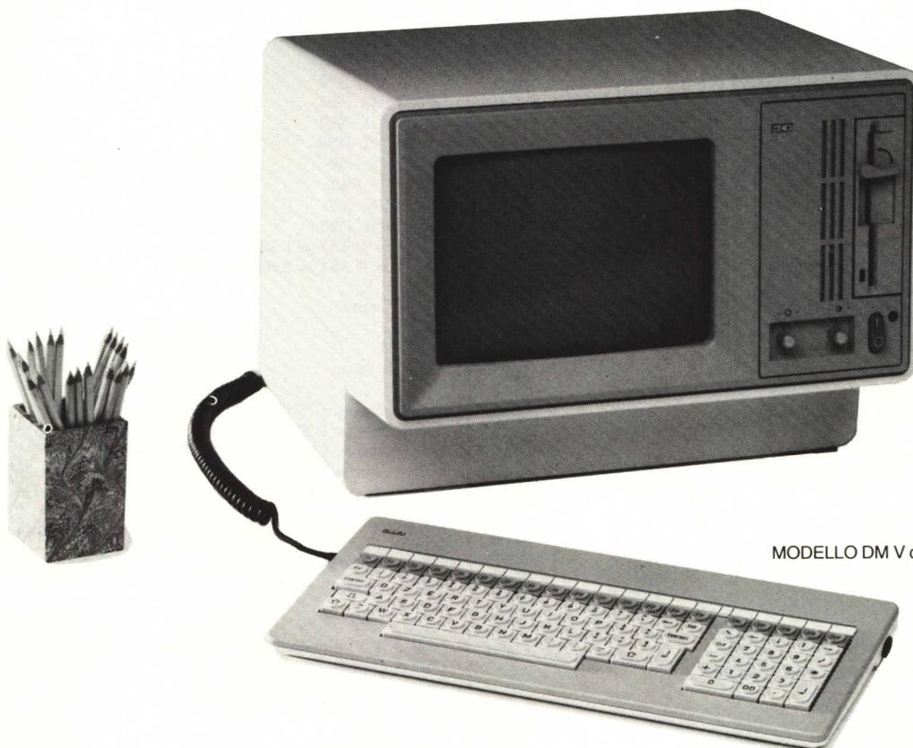
MODELLO DM V con disco Winchester da 10 MB.
