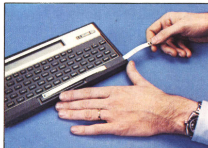
Il lettore di schede a trascinamento manuale: incredibile, ma funziona perfettamente.
