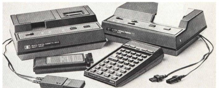
Come? Grazie al nuovo sistema d'interfacciamento HP-IL progettato per i calcolatori personali. Ed ecco che l'HP 41 diventa capace di controllare strumenti e periferiche interattive: come stampanti, strumenti di misura e memorie di massa a cartuccia (131000 byte). In più, puoi collegarti direttamente con un personal computer HP per realizzare ulteriori applicazioni tecniche, scientifiche o gestionali.
