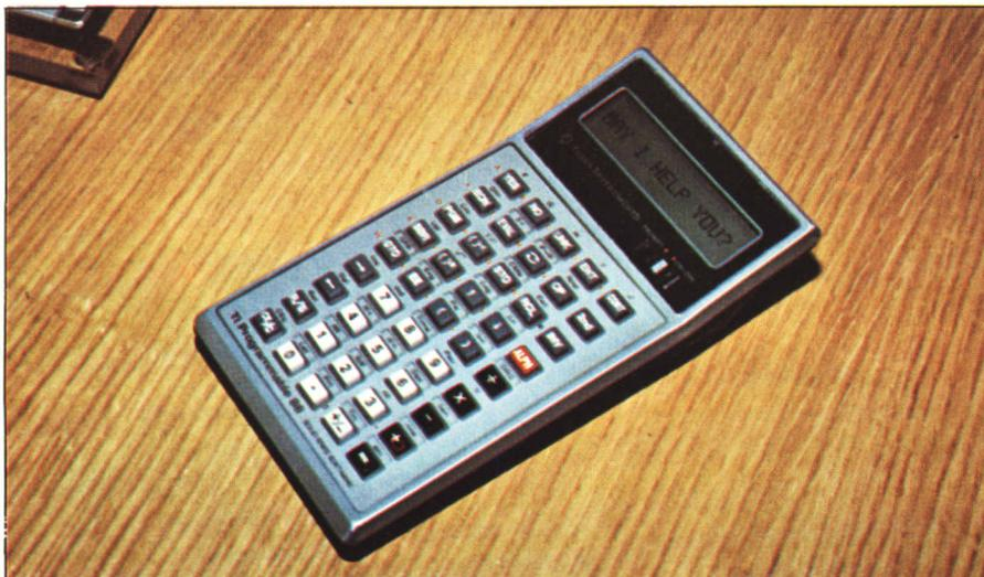
e delle istruzioni permettono di far uscire sulla presa il contenuto del display e viceversa, per cui, almeno potenzialmente, potrebbe collegarsi con un'ampia gamma di periferiche. Al momento attuale è già possibile il collegamento di 2 TI-88 in configurazione Master-Slave e si conoscono le caratteristiche di massima della stampante termica PC 800 (set di caratteri come la 88, 16 colonne, 3 righe al secondo).
