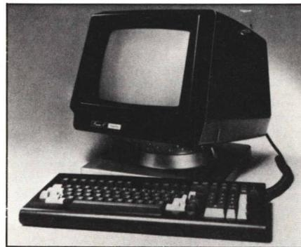
È stato ora annunciato l'Esprit II, che mantiene le caratteristiche del I con nuovo design, tastiera separata e video orientabile. Altra novità l'Executive 10, con video ad alta risoluzione con caratteri a matrice 7x10 e possibilità di tracciare linee.
