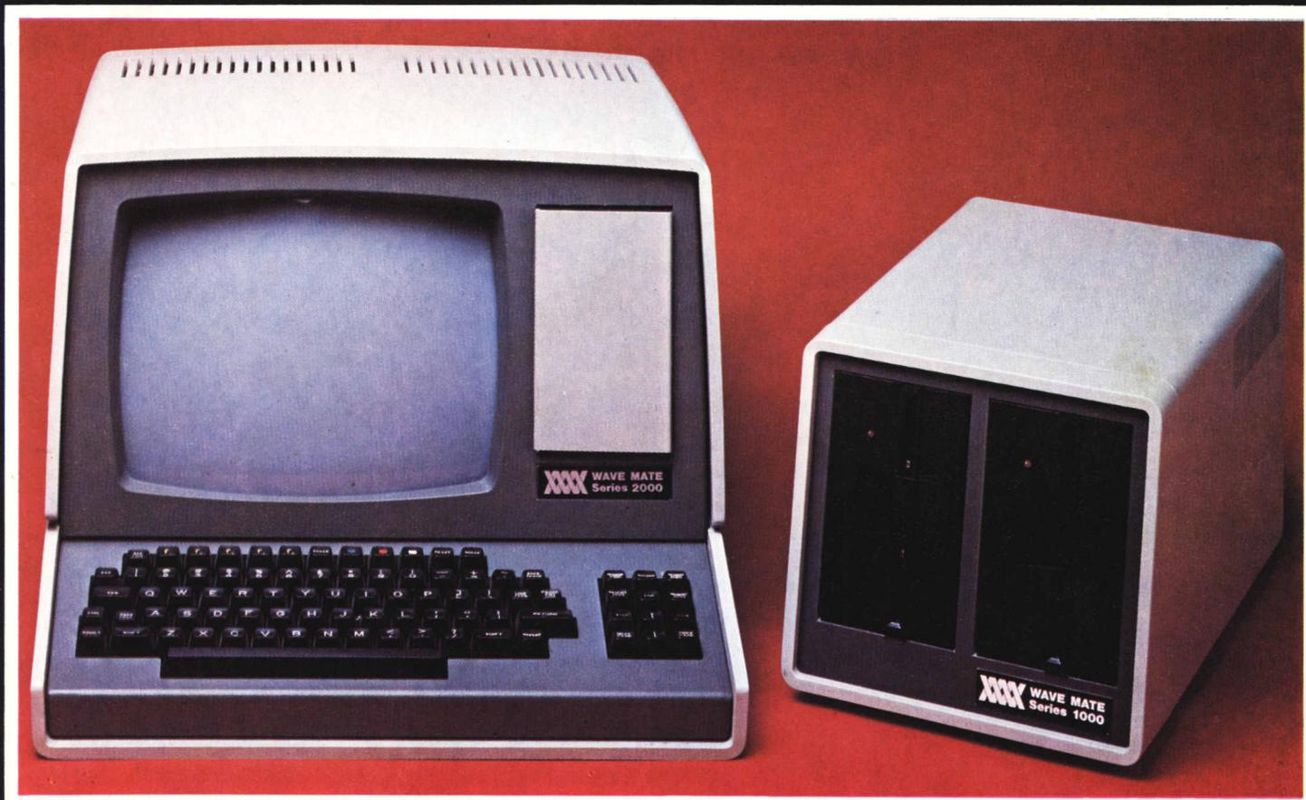
CPU a doppio processore: Motorola 68B00 come unità di elaborazione e Z80 per il controllo del video e della tastiera.
