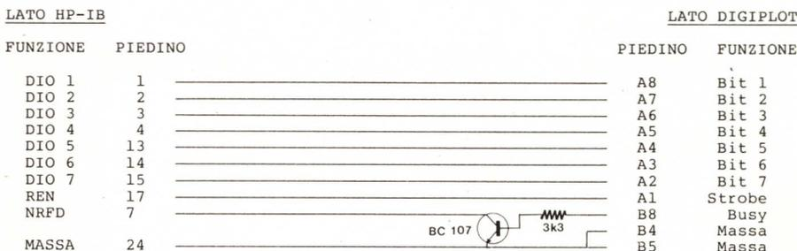
Figura 1. Schema elettrico del cavo per il collegamento diretto di periferiche con interfaccia parallela a protocollo Centronics al Bus IEEE 488 (HP-IB o GP-IB). Per la gestione della periferica è necessario simulare da software il protocollo Centronics sull'HP-IB.
