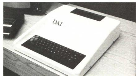
punti di vista della grafica a colori, della musica e dei calcoli scientifici. Costa 1.480.000 + IVA con 48 K di RAM, 24 K di ROM, 2 interfacce per cassette e 2 per paddle, uscita DIN per amplificatore stereo, uscita per tv color (PAL) e interfaccia per floppy disk.
