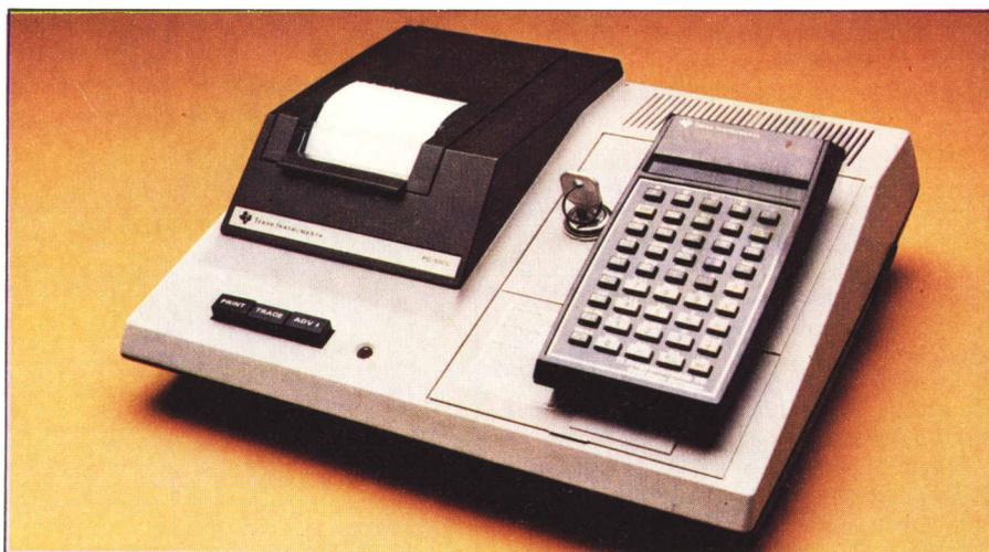
Foto 3 - Con l'RPN simulator è quasi indispensabile la stampante PC-100C; l'output è costituito dall'eventuale "check input" e dalla traduzione del programma da RPN a SOA.
