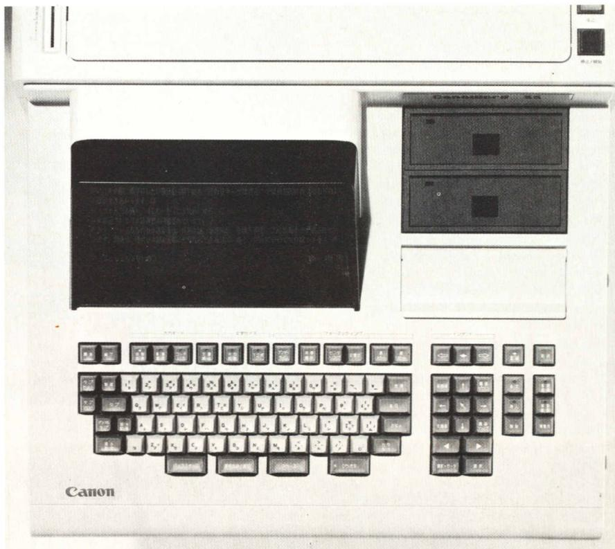
**Canon Word 55.** Un sistema completo destinato per ora al solo mercato interno ed orientato verso il text processing, una tipica applicazione "da ufficio". Tastiera, minifloppy, stampante, video a fosfori verdi da 46 caratteri per 16 righe, possibilità di scrivere non solo in Katakana ma anche in Hiragana, l'ideale per usi commerciali.
