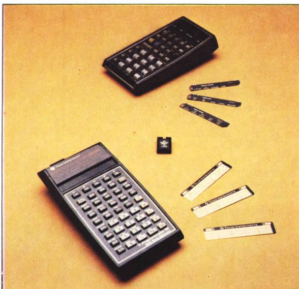
Foto 4 - Al centro della foto, il modulo RPN simulator. In primo piano la TI-59 e sullo sfondo l'HP-67, ciascuna con le sue schede.
