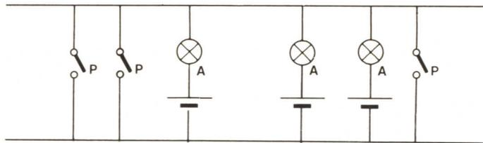
Figura 4. Le periferiche e il controller collegate sul Bus HP-IB possono essere assimilate ad interruttori se svolgono la funzione di parlatore e di lampadine in serie ad una batteria se svolgono la funzione di ascoltatore. Quando uno o più degli interruttori sono chiusi, lo stato logico della linea è 1. Se tutti gli interruttori sono aperti, lo stato logico della linea è 0. Nella pratica gli interruttori sono costituiti da transistor o "Bus driver" e le lampadine da porte o "receiver".
