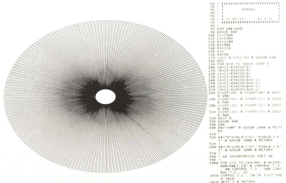
Figura 6. Ragghera ellittica. Se i vettori da tracciare sono relativamente lunghi, il tempo di esecuzione con l'interfaccia software sale in percentuale accettabile. Nell'esempio, da 16,8 minuti con interfaccia hardware, si passa a 20,02 minuti con interfaccia software: un incremento percentuale del 20%.
