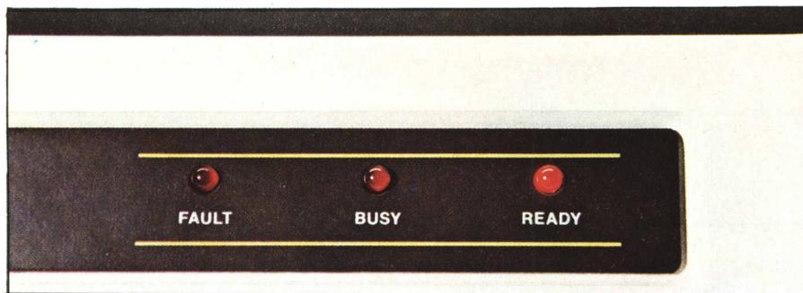
Foto 1. Sulla destra del pannello frontale ci sono tre LED che segnalano Fault, Busy e Ready, cioè errore, in uso e pronto.
