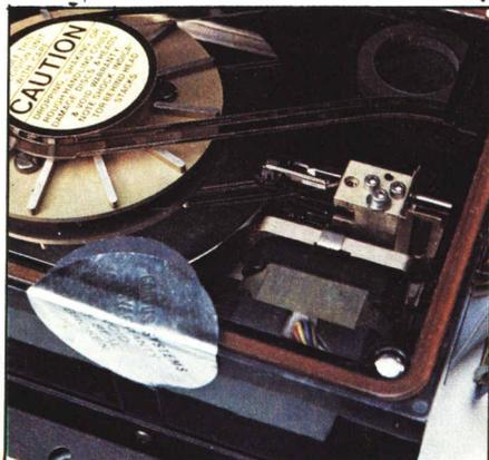
Foto 6. Particolare delle quattro testine Winchester.
