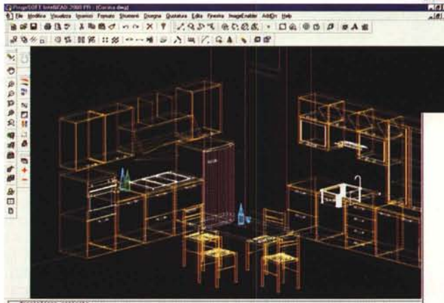
Alcuni esempi, in wireframe e in rendering finale, presi dalle librerie fornite con il programma. L'operazione di rendering di superfici anche molto complesse è pressoché istantanea.
