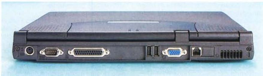
*Le capacità di espansione del TravelMate 210TER si concretizzano in porte e connettori concentrati quasi esclusivamente sul lato posteriore del portatile: sono qui visibili, privi di sportelli di protezione, il connettore PS/2 per mouse o tastiera esterni, le porte seriale e parallela, una doppia interfaccia USB, il connettore SVGA a 15 pin e quello RJ11 del modem integrato.*
