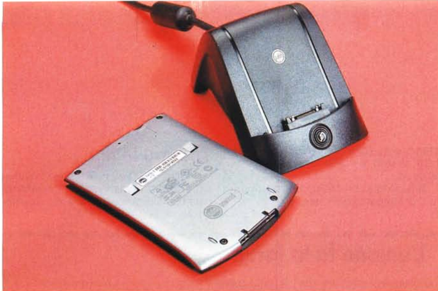
Ben visibile, al centro, il connettore universale per il collegamento del Dock da tavolo e di add-on opzionali.
