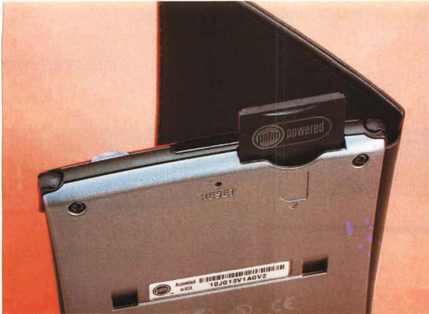
Nella vista di tre quarti posteriore sono ben visibili, lungo il bordo superiore della macchina, l'alloggiamento per la scheda di espansione, l'asola lucida centrale della porta a infrarossi ed il pulsante di accensione. Al centro della parte alta del pannello posteriore si nota il minuscolo forellino di Reset.
