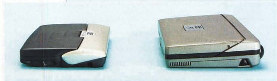
A confronto il meccanismo di apertura dello Psion Revo e del Series 5. Si noti come in entrambi i casi la tastiera scivoli all'interno al momento della chiusura.
