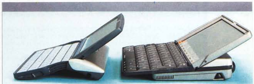
A confronto il meccanismo di apertura dello Psion Revo e del Series 5. Si noti come in entrambi i casi la tastiera scivoli all'interno al momento della chiusura.
