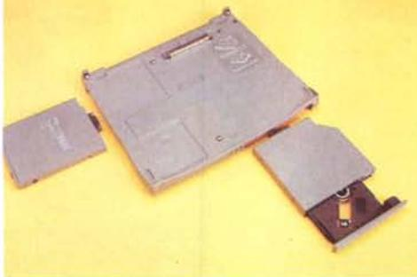
Nella configurazione giuntaci in prova è compresa una pratica e semplice docking station opzionale, la Mobile DeskDock, in grado di contenere i drive del floppy e del DVD-ROM - altrimenti collegabili esternamente al notebook tramite cavo proprietario in dotazione -, un'eventuale batteria supplementare, in uno slot utilizzabile anche come carica batterie, e alcune porte supplementari tra cui una doppia Firewire, a 4 e 6 pin.
