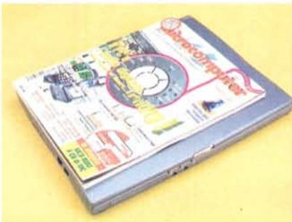
Il 410 è un notebook dalla massima portabilità, leggero e dalle dimensioni estremamente contenute: 298 x 236 x 30 mm per 1,9 kg di peso compresa la batteria. Senza con questo dover rinunciare ad un display con una diagonale di tutto rispetto come è quella da oltre 13 pollici del TFT in dotazione.
