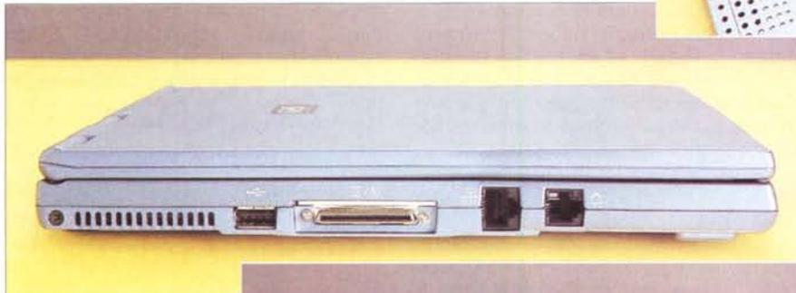
zione utilizzata, corrente o batteria) su chipset Intel 440BX-100 e prevede 128 MB di SDRAM, un disco rigido da 20 GB, display TFT da 13,3", DVD-ROM 8x e drive per floppy disk collegabili esternamente, batteria agli ioni di litio, audio stereo, modem/fax e scheda di rete integrata.
