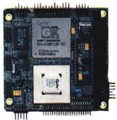
Un "single board computer": la scheda CPU-1231, in formato PC104, della Eurotech di Udine ( http://www.eurotech.it/ ) è basata su un processore MediaGX a 266 MHz, compatibile con la famiglia x86. Essa dispone di controller IDE, floppy, SVGA, PS/2, 2 USB e FastEthernet integrati, oltre che di due porte seriali ed una parallela. Monta fino a 128 MB di RAM ed è possibile aggiungere un Disk-On-Chip di capacità fino a 128 MB. Per l'alimentazione è sufficiente una singola tensione di +5 V. E' possibile espandere il sistema mediante moduli in formato PC104.
