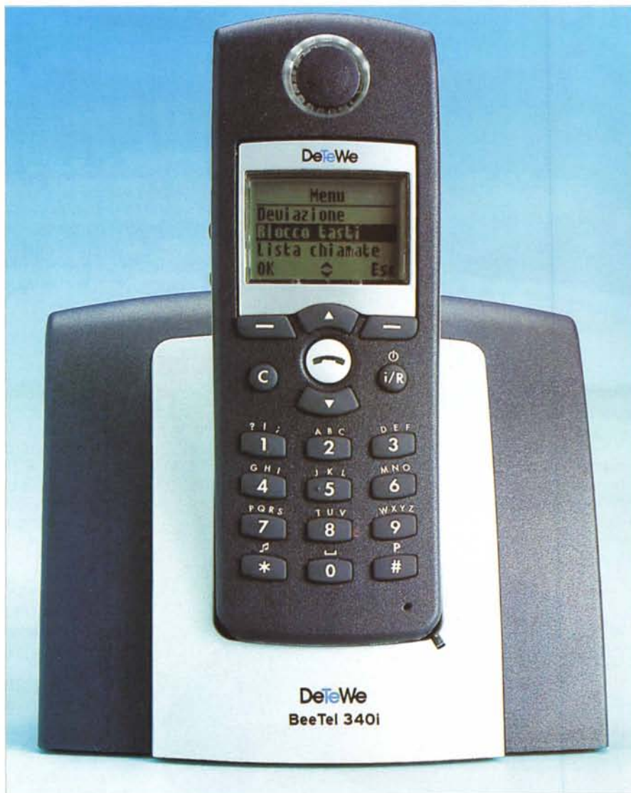
Molto curato sotto il lato estetico il BeeTel 340i offre un display grafico retroilluminato a 5 righe. Anche la tastiera, ovviamente, dispone di illuminazione propria.
