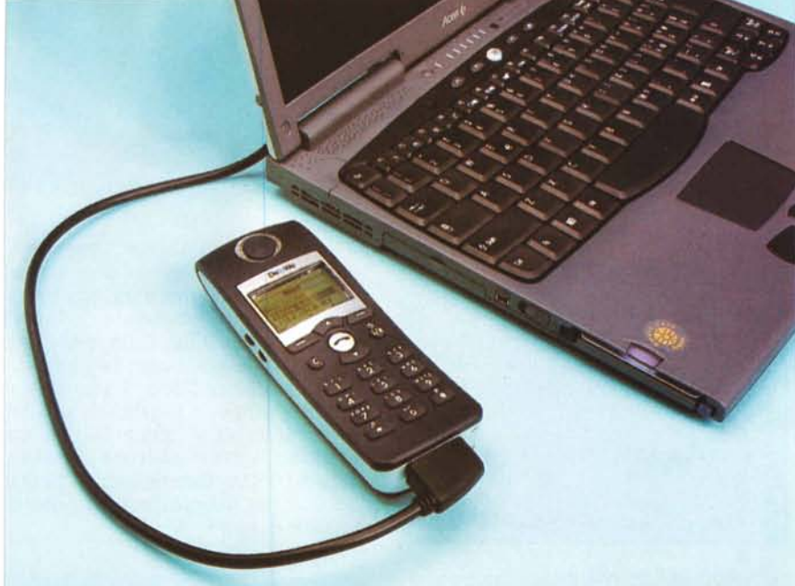
Il cordless può essere collegato anche direttamente, sempre tramite porta seriale, utilizzando un secondo cavetto fornito a corredo.
