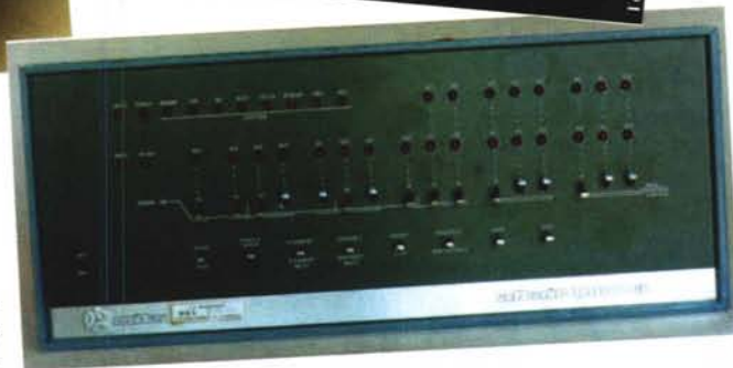
L'Altair 8800 può facilmente essere considerato il capostipite di tutti i personal computer. Fu proposto nel 1975 dalla rivista Popular Electronics sotto forma di progetto.
