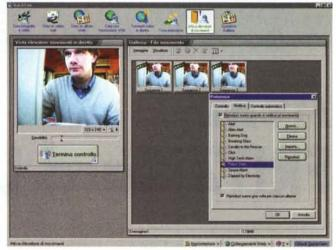
Il software Digital Radar II trasforma la periferica in un vero rilevatore di movimenti. Una volta attivato il controllo dell'ambiente, l'applicazione registrerà ogni eventuale movimento segnalandolo con un allarme acustico.
