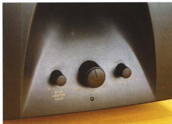
I controlli sono tutti sul pannello anteriore del sub. Da qui si può regolare il volume generale e quello degli altri canali utilizzando in tutto tre manopole. La prima (quella più grande) regola il volume generale del sistema, quella a sinistra la percentuale di segnale inviato ai canali effetti (surround e subwoofer) e quella a destra regola il solo livello del sub.
