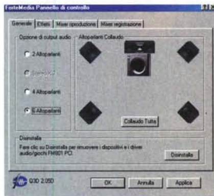
Nel pannello di controllo del dispositivo è possibile decidere la configurazione di altoparlanti da utilizzare, fino a 6 speaker, e l'utilizzo o meno di effetti.
