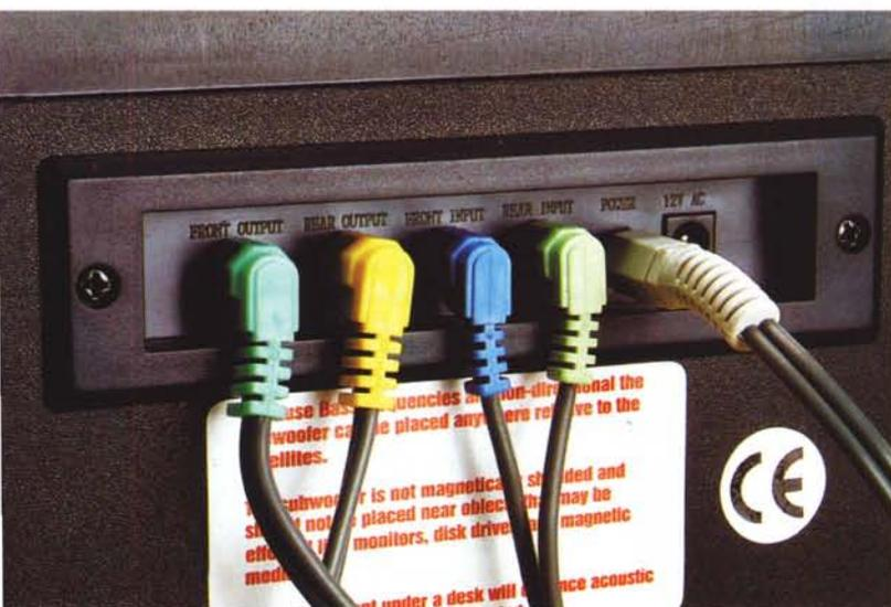
*Ecco un tipico collegamento a quattro canali con subwoofer. Le doppie uscite stereo della scheda vengono collegate agli ingressi dell'amplificatore che provvede solo ad amplificare i segnali, senza effettuare nessuna decodifica. Da qui poi il segnale amplificato viene inviato ai quattro satelliti, due anteriori e due posteriori. Il segnale del subwoofer viene ricavato filtrando dai canali anteriori, con un filtraggio in bassa frequenza.*
