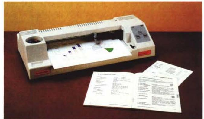
Un bel plotter formato A3 della Océ, il Graphics G1012, dotato di carousel di sei penne e precisione di riposizionamento inferiore a 0,1 mm
