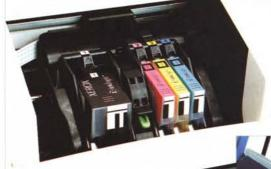
L'apertura dello sportello superiore fa immediatamente spostare il carrello porta testine in posizione centrale per le operazioni di sostituzione, semplici e intuitive sia per la sostituzione dei serbatoi, separati per ogni pigmento, sia per il cambio delle testine, operazione necessaria dopo la stampa di 10000 copie.
