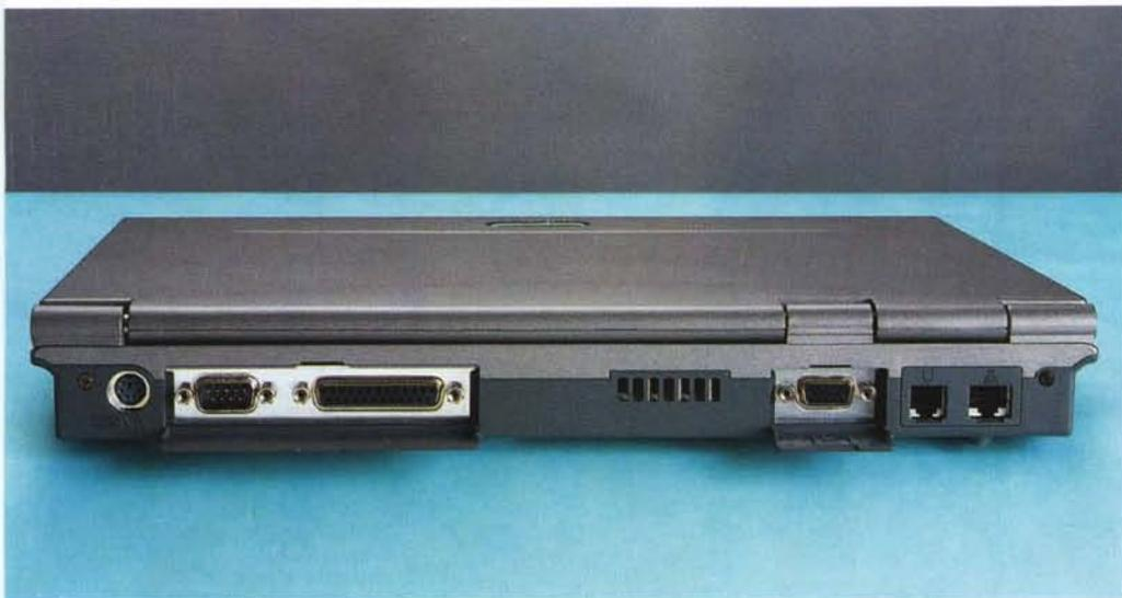
Due piccoli sportelli sul retro dell'apparecchio proteggono le porte parallela e seriale da una parte e SVGA dall'altra. Sono inoltre visibili sulla sinistra la porta PS/2 per mouse o tastiera esterni e sulla destra i due connettori RJ11 ed RJ45 rispettivamente del modem e dell'adattatore Fast Ethernet integrati.
