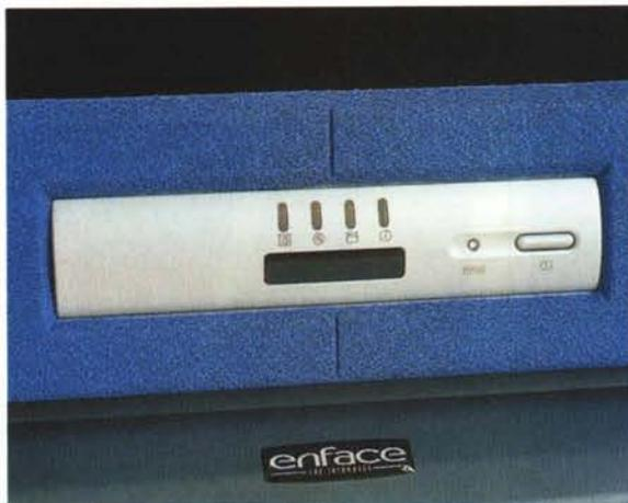
Il pannello frontale dell'Envidea 200 integra, oltre al pulsante di accensione e ai led di stato, la consistente porta ad infrarossi. La posizione frontale di quest'ultima si rivela particolarmente utile nel caso si decida di utilizzare delle periferiche di input che sfruttino questo tipo di interfaccia; ma anche per il normale collegamento ad un notebook, ad un palmtop o ad un PDA.
