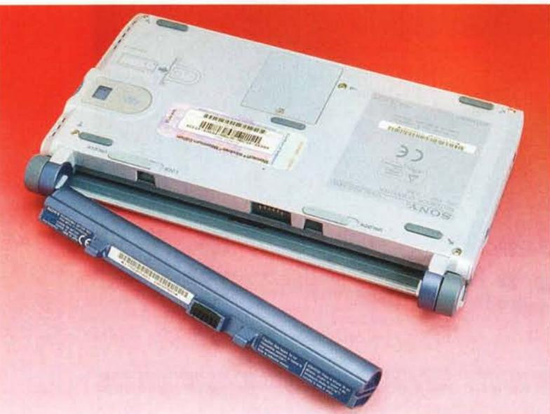
La compatta batteria di forma cilindrica agli ioni di litio eroga 1800 mAh e, grazie ai consumi contenuti del Vaio, ne garantisce il funzionamento per circa 3 ore.
