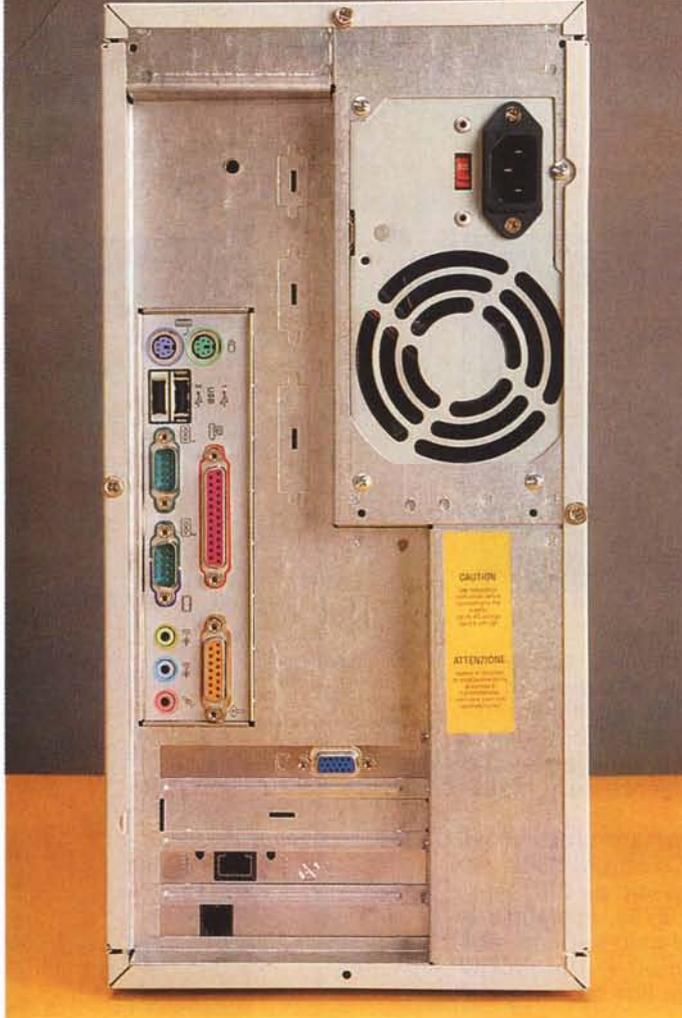
*Sull'esemplare in prova sono montate due schede aggiuntive: una scheda LAN Ethernet da 100 megabit e un modem 56k. La prima in realtà non viene fornita con il computer, e va quindi richiesta appositamente, mentre il modem fa parte della dotazione standard del computer.*
