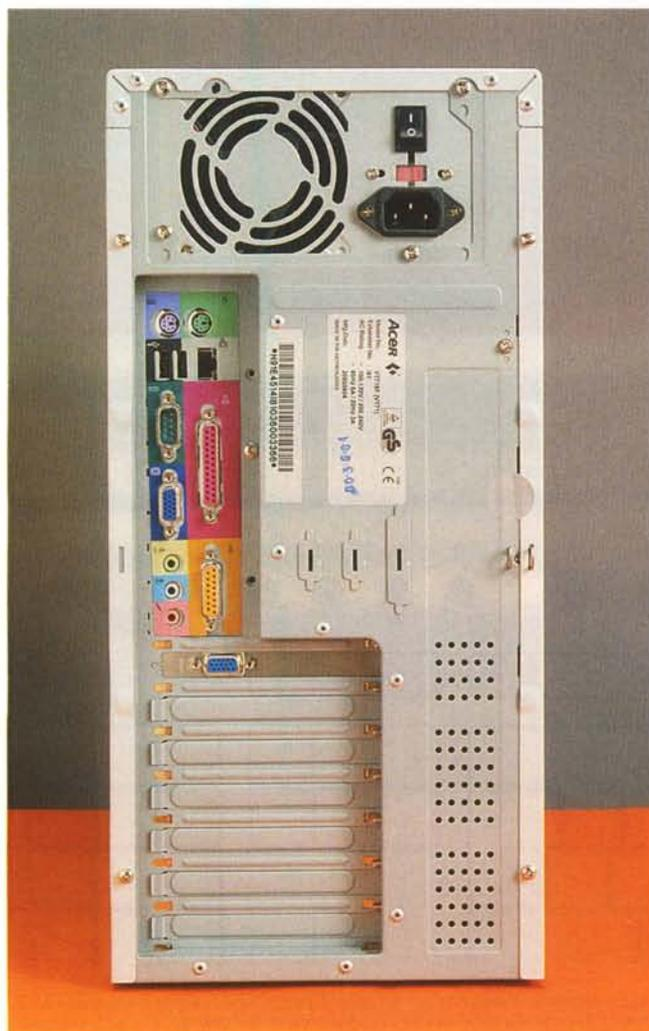
*Sulla parte posteriore del mobile troviamo classiche prese di collegamento, cioè due seriali, una parallela, le due USB, gli ingressi e le uscite audio (l'ingresso del microfono è duplicato), la presa joystick, mouse e tastiera. Inoltre troviamo anche una presa per il collegamento alla rete, di tipo RJ 45 mentre l'hardware corrispondente è integrato sulla motherboard.*
