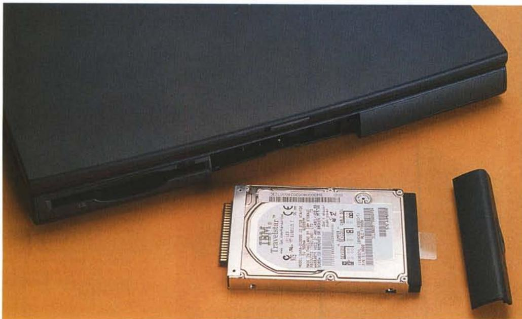
*Il disco rigido adottato in entrambi i modelli è un IBM Travelstar, Ultra ATA/33 veloce ed affidabile, con una capacità di 5 GB nel caso del TM200T e di 12 GB nel caso del TM522TXV. L'unità disco è protetta da un sistema interno di ammortizzamento degli urti e può essere estratta dal suo vano anteriore ed eventualmente sostituita rimuovendo la vite di bloccaggio sul fondo del PC.*
