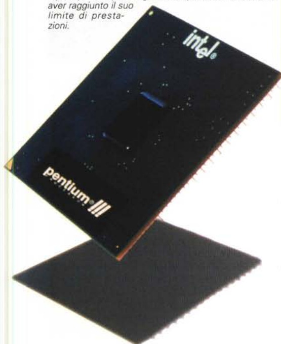
Il Pentium III nasce sull'ingombrante slot di cui si libererà ben presto. La miniaturizzazione a 0.18 micron consente le ben note, straordinarie frequenze.
