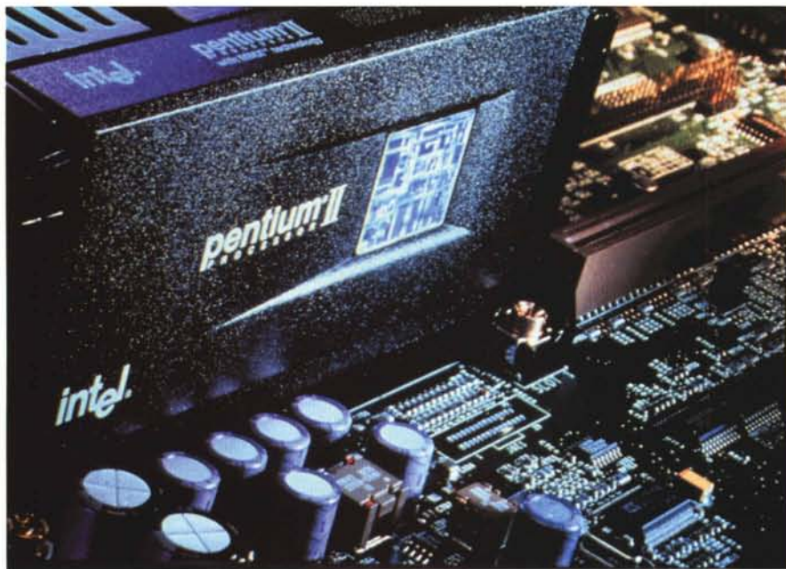
Il Pentium II si presenta con un aspetto ed un sistema di montaggio del tutto nuovi, ma le similitudini a livello architetturale col suo predecessore Pentium Pro sono evidenti.
