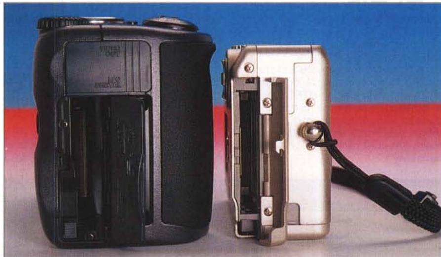
Solo la Canon, tra le due fotocamere, offre la possibilità di montare CompactFlash di tipo II. Lo si può dedurre anche dalla fessura di dimensioni leggermente superiori, in grado di ospitare lo spessore di un Microdrive IBM, il piccolo hard disk da 170 o 340 MB.
