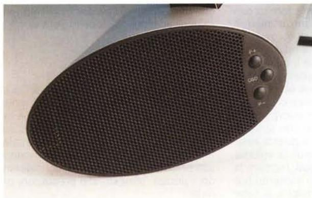
*Gli altoparlanti sono posti ai lati del monitor, agli estremi del grosso "tubo" ellittico in alluminio. Accanto ad essi trovano posto alcuni tasti per la regolazione del televisore e del monitor, che vengono utilizzati anche per la regolazione del volume audio e per la scelta del canale televisivo.*
