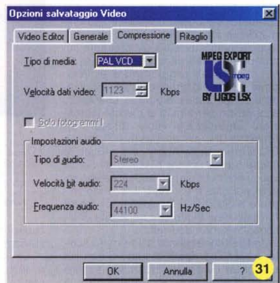
30 e 31 - I parametri per un filmato Video-CD sono compressione MPEG-1, 25 fotogrammi al secondo, 352x288 pixel, bitrate fisso pari a 1123 bit al secondo.
