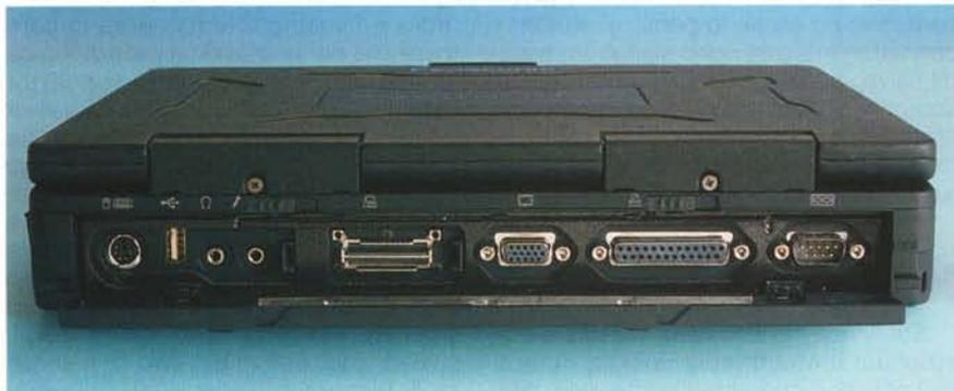
Anche il lato posteriore è completamente protetto da un ampio sportello basculante, dietro il quale sono visibili la porta PS/2 per mouse o tastiera esterni, il connettore USB, le prese jack per ingresso e uscita audio, il connettore per il port-replicator opzionale, la porta SVGA per monitor esterno, parallela e seriale. Una finestrella a scorrimento laterale consente l'utilizzo del port-replicator anche a sportello chiuso.
