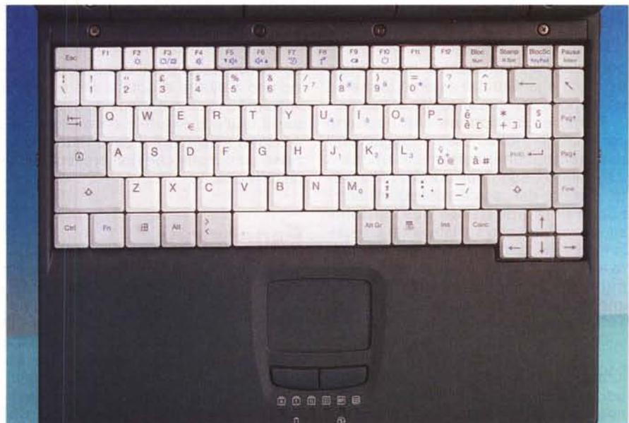
La capacità del CF-27 di resistere alle intemperie si concretizza anche in un'accurata impermeabilizzazione di tutte le parti sensibili. Non fanno eccezione la tastiera ed il touch-pad integrato, che non mostra però alcuna perdita in efficacia e sensibilità. Lo stesso dispositivo di puntamento può essere utilizzato alla stregua di una piccola tavoletta grafica, grazie al software Panasonic Hand Writing precaricato.
