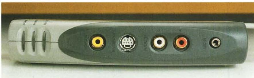
Il Digital Video Creator è un dispositivo esterno piuttosto piccolo ma che dispone di ingressi e uscite audio stereo e video. Gli ingressi sono posti anteriormente, in maniera da favorire un collegamento rapido ad apparecchiature quali telecamere o videoregistratori, le uscite invece sono sulla parte posteriore.
