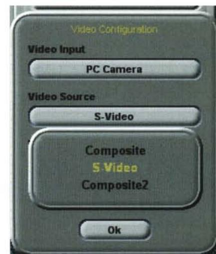
Tramite una apposita finestra è possibile scegliere la sorgente di ingresso, tra composita e s-video. Composite2 è utilizzabile solamente con apparecchi che dispongono di due ingressi.
