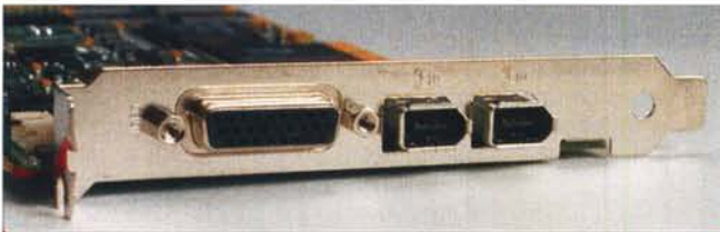
Direttamente sulla scheda sono poste le prese Firewire per l'iso in standard DV. Accanto è visibile il grosso connettore multipolare per il collegamento con il box di connessione esterno.
