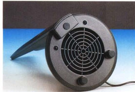
L'altoparlante destinato alla riproduzione della gamma medio-bassa trova posto nella base del satellite. Montato rivolto verso la superficie di appoggio, ne sfrutta le capacità riflettenti per l'emissione in ambiente.
