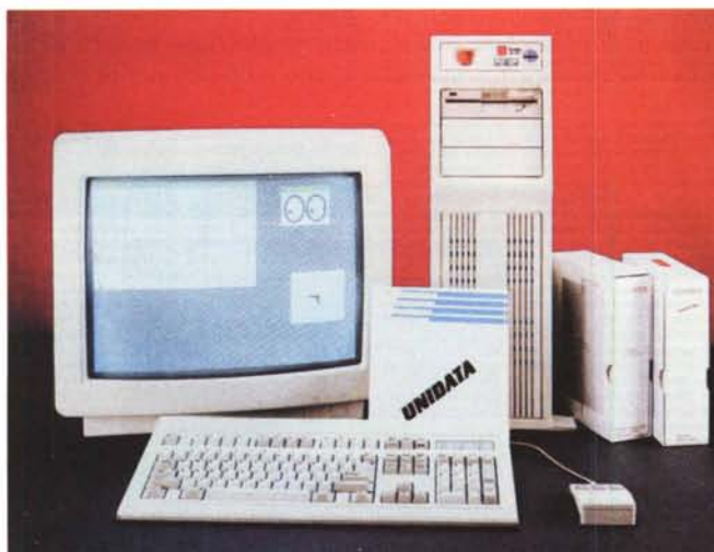
Unidata AX900, un 486 dotato di 2MB di RAM e di un disco da 80MB che costava oltre dieci milioni e con cui, allora, si poteva gestire un sistema aziendale in multiutenza.
