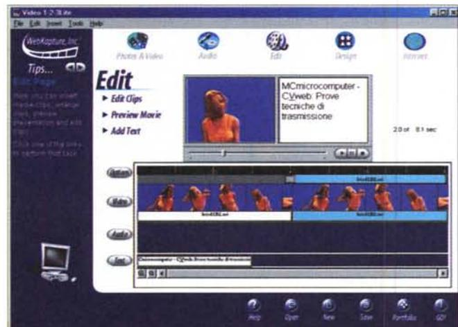
Figura 4 - WebKapture. Il modulo di editing: inserimento delle tracce audio e video, loro sincronizzazione e sovrimpressione di titoli. In alto la finestra di preview.
