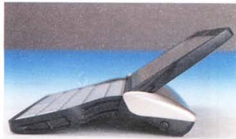
Il meccanismo di apertura dello Psion Revo ha quasi dell'incredibile: si passa dalla configurazione chiusa, praticamente piatta, a quella aperta, ergonomicamente ricurva, grazie al meccanismo a molla e al dispositivo bi-valva.
