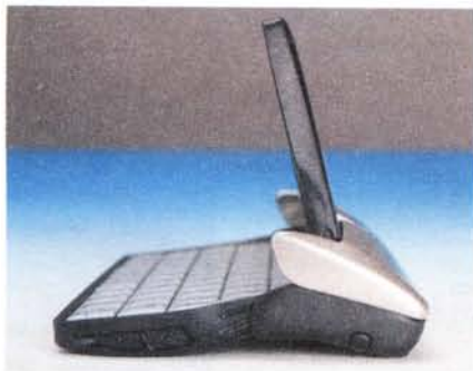
Il meccanismo di apertura dello Psion Revo ha quasi dell'incredibile: si passa dalla configurazione chiusa, praticamente piatta, a quella aperta, ergonomicamente ricurva, grazie al meccanismo a molla e al dispositivo bi-valva.
