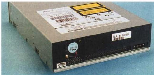
Sul pannello posteriore notiamo il grosso pettine per la connessione SCSI, il connettore per l'alimentazione e i ponticelli per la scelta dell'ID del canale SCSI. Accanto a questi, sono presenti alcuni pin per le connessioni audio
