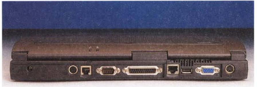
Il retro, come tradizione, ospita le porte di connessione prive di sportellino di protezione. Da notare il connettore S-video sulla destra e l'uscita della scheda di rete integrata.
