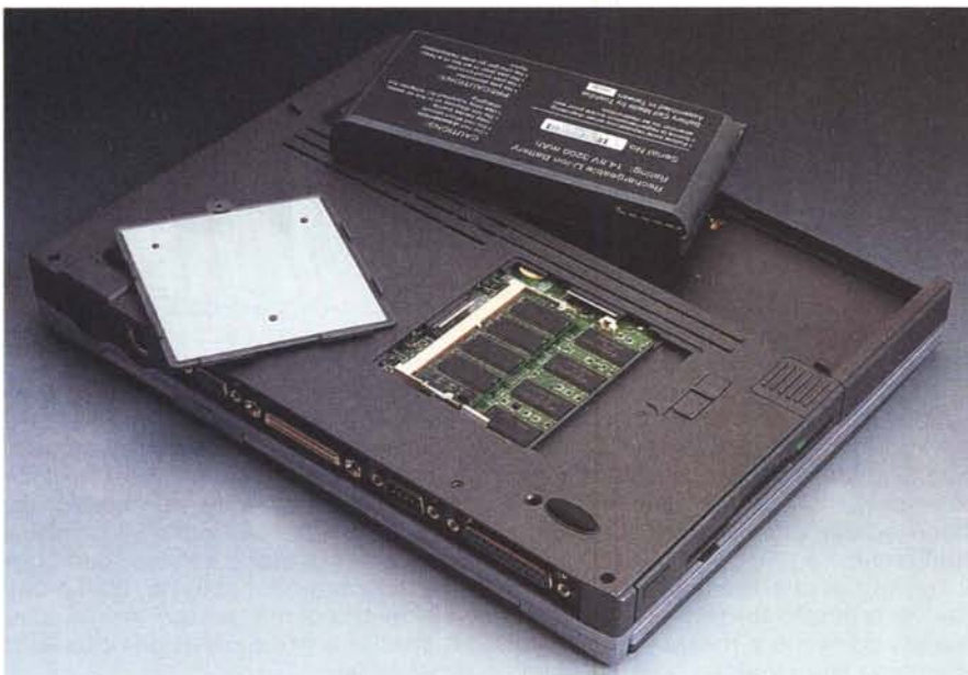
Sotto il notebook si trova il vano batterie di grandi dimensioni, per garantire allo Zen un'autonomia di circa 4 ore. Sempre sul fondo trova posto, celato da uno sportellino, il connettore di espansione della RAM.
