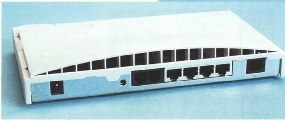
*Sul pannello posteriore dell'Office Connect sono presenti, oltre al connettore di alimentazione e al pulsante di reset, anche due porte telefoniche, alle quali connettere normali telefoni, quattro connettori Ethernet e la presa ISDN.*
