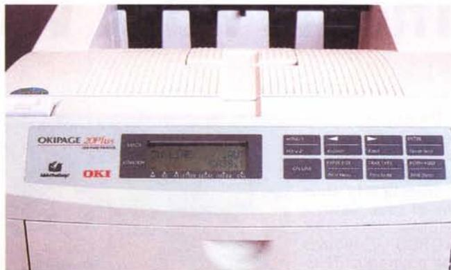
Il pannello frontale e l'ampio display LCD servono in caso di errore della stampante, per monitorarne lo stato e nei rari casi in cui sia necessario cambiare le impostazioni di default. In tutti gli altri casi la stampante è completamente governata dai driver software forniti per Windows e Mac.
