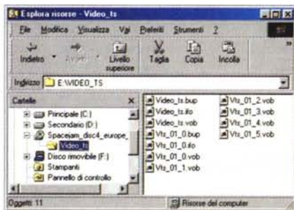
Figura 2 - Lo standard DVD prevede una struttura delle informazioni registrate sul disco abbastanza rigida e complessa. Innanzi tutto i file video originali devono essere convertiti in MPEG-2, con una dimensione del quadro di 720x576 pixel ed un bitrate di 9,8 megabit al secondo. Poi il disco deve necessariamente contenere una directory di nome Video_ts. Nella directory sono poi presenti diversi file tra i quali vediamo alcuni con estensione .IFO, alcuni con estensione .BUP ed infine alcuni con estensione .VOB
