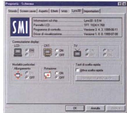
La scheda video integrata è una Silicon Motion Lynx3D, dotata di 6,5 megabyte di RAM e capace di accelerazione 2D e 3D che riesce a pilotare, oltre che lo schermo LCD anche un normale CRT collegato all'apposita uscita SVGA posteriore.
