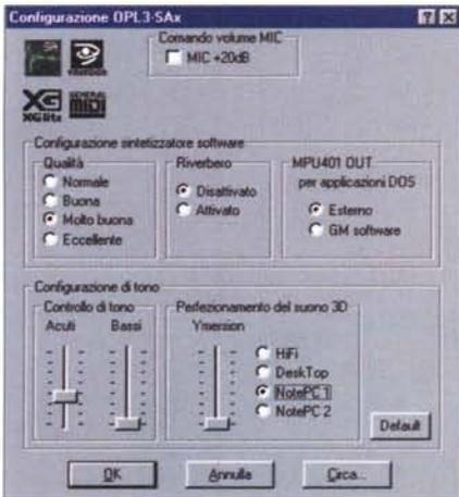
La scheda audio incorporata adotta un chip Yamaha sia per la gestione dell'audio digitale che per il MIDI. Quest'ultimo si basa sulla sintesi FM che wavetable mentre la scheda supporta frequenze di campionamento da 8 kHz a 44,1 kHz.
