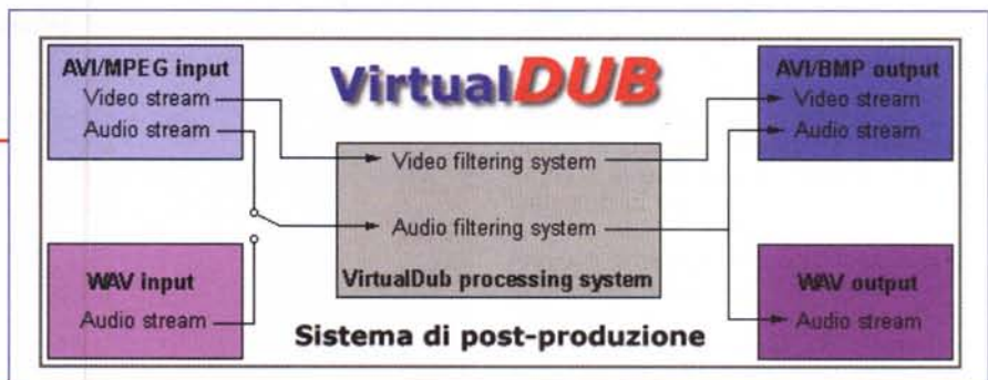
Figura 5 - VirtualDUB: lo schema di massima delle operazioni che l'editing/capture freeware è in grado di operare. Da segnalare che tale applicativo è in grado di operare in batch per mezzo di un proprio linguaggio di scripting
