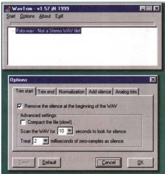
Figura 3 - WavTrim è una utility in grado di compattare sintesi audio in formato .Wav rimuovendo da queste eventuali zone di silenzio spesso presenti ad inizio e fine sintesi.
