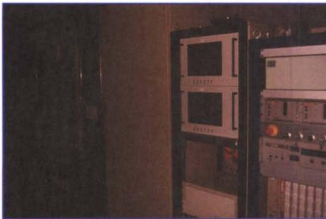
Parte delle attrezzature elettroniche di gestione della macchina "costruisci CD", in particolare il pannello dell'energia elettrica e i display di controllo del corretto funzionamento.
