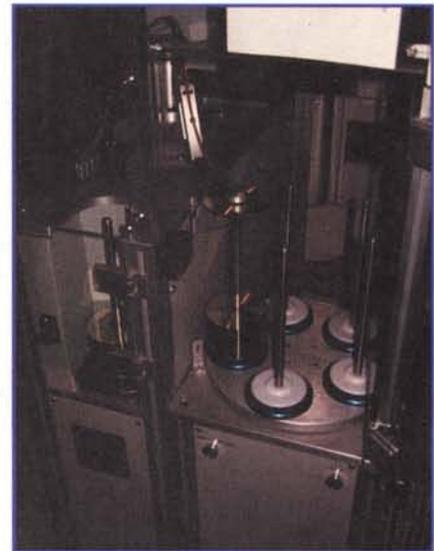
Oltre ai controlli effettuati automaticamente dalla macchina durante la fase di costruzione, vengono fatti sui CD anche dei controlli a campione durante varie fasi costruttive. Questa macchina controlla la superficie del CD dopo che è stato sovrapposto il dye e misura la rispondenza con gli standard impostati.
