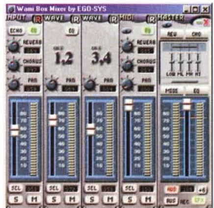
La dotazione software del WaMi Box comprende anche un programma di mixer che consente un completo controllo di tutto il sistema. Con questo programma è possibile variare il livello degli ingressi e delle uscite e inserire o meno alcuni effetti, come chorus, riverbero e un equalizzatore grafico, di questi. Da notare la ottima grandezza e precisione delle barre LED, indispensabili per la giusta regolazione del livello di ingresso.
