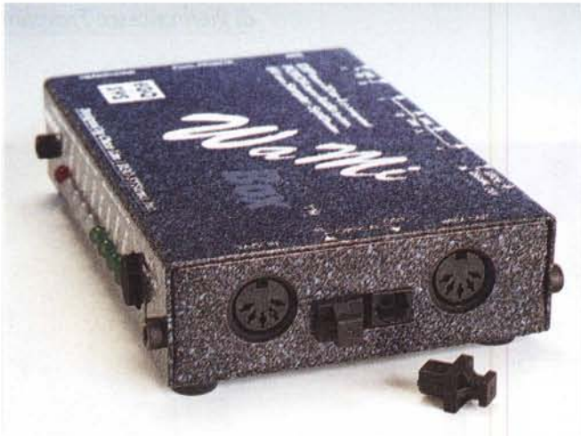
Su uno dei lati più corti sono presenti le prese digitali ottiche, con connettori TOSLINK e le due prese MIDI IN e OUT realizzate con le classiche prese DIN a cinque poli. Sul lato opposto troviamo l'ingresso microfonico stereo e l'uscita cuffia.
