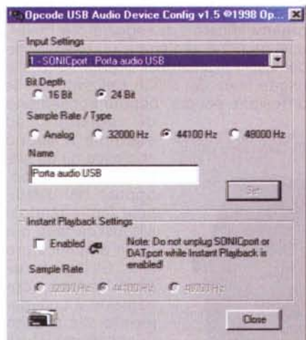
Nella dotazione del software troviamo anche un programma che ci consente di modificare la configurazione del sistema; in particolare è possibile modificare la frequenza di campionamento tra 32, 44.1 e 48 kHz e l'ampiezza dei campioni audio tra 16 e 24 bit.
