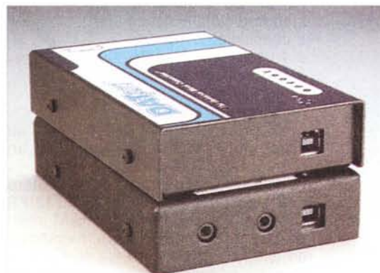
Nella parte posteriore, oltre al connettore USB troviamo anche, nel caso della SONICport, la coppia di prese mini jack per le connessioni stereofoniche analogiche di ingresso e uscita
