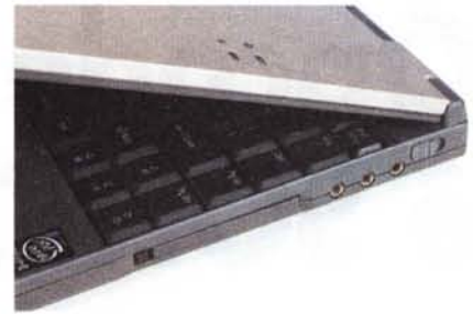
Sulla parte destra troviamo le connessioni audio, realizzate con i consueti mini jack stereo e lo slot per la scheda PCMCIA oltre al tasto di accensione.
