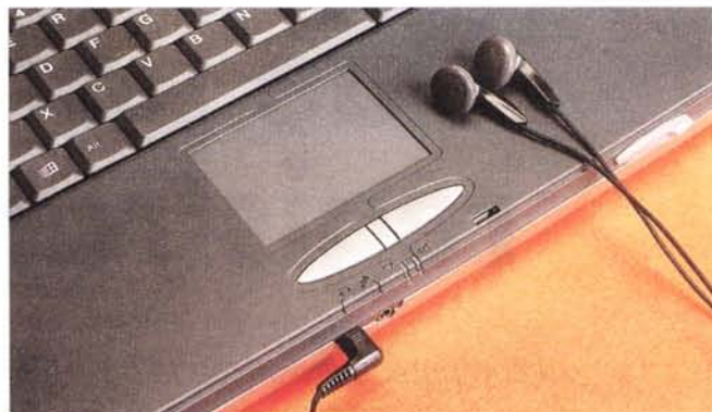
Le prese audio sono poste anteriormente, in prossimità della parte centrale e sono realizzate con i consueti mini jack stereofonici.
