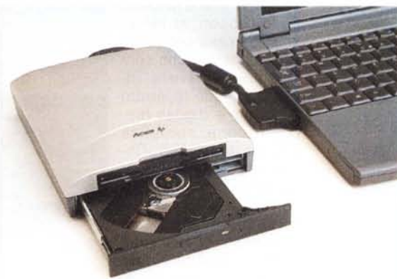
Il lettore CD-ROM e il drive per i floppy sono situati in un box esterno che si collega al computer mediante un cavo ed un connettore multipolare posto lateralmente.
