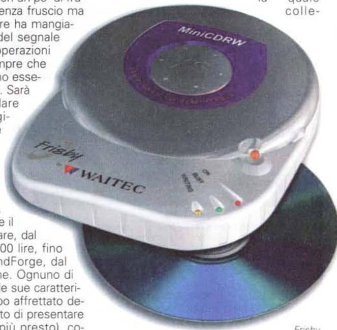
Frisby è un masterizzatore della Waitec che si collega al computer tramite l'interfaccia USB. Appare ideale quindi per l'utilizzazione con computer portatili, ai quali assicura una velocità in lettura di 32x e in scrittura-ri-scrittura di 4x
