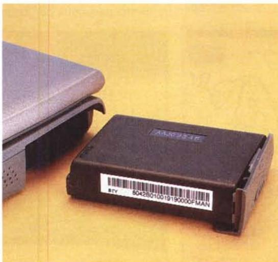
*La batteria agli ioni di litio è, come tutto il resto, miniaturizzata. L'autonomia, nell'uso intensivo, è di circa 2 ore, che è anche il tempo necessario ad una ricarica completa.*
