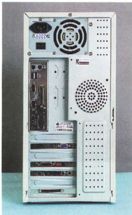
Nella foto del pannello posteriore notiamo la presenza delle uscite della scheda Korg e della scheda aggiuntiva Soundblaster, oltre all'uscita ausiliaria SCSI.
